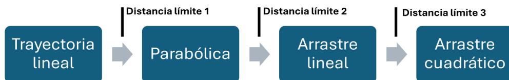
Figura 1. Esquema de evolución de modelos, iniciando con el que menos datos físicos considera y más simple, la trayectoria lineal. Él que en orden se transforma modelos más sofisticados: trayectoria parabólica, con arrastre lineal y con arrastre cuadrático. La decisión de utilizar un modelo se fundamenta en un criterio. Si dos modelos son equivalentes se puede usar el más sencillo, hasta una distancia límite. Es de esperar que las distancias límites entre modelos sean mayores dependiendo de las condiciones implicadas.
