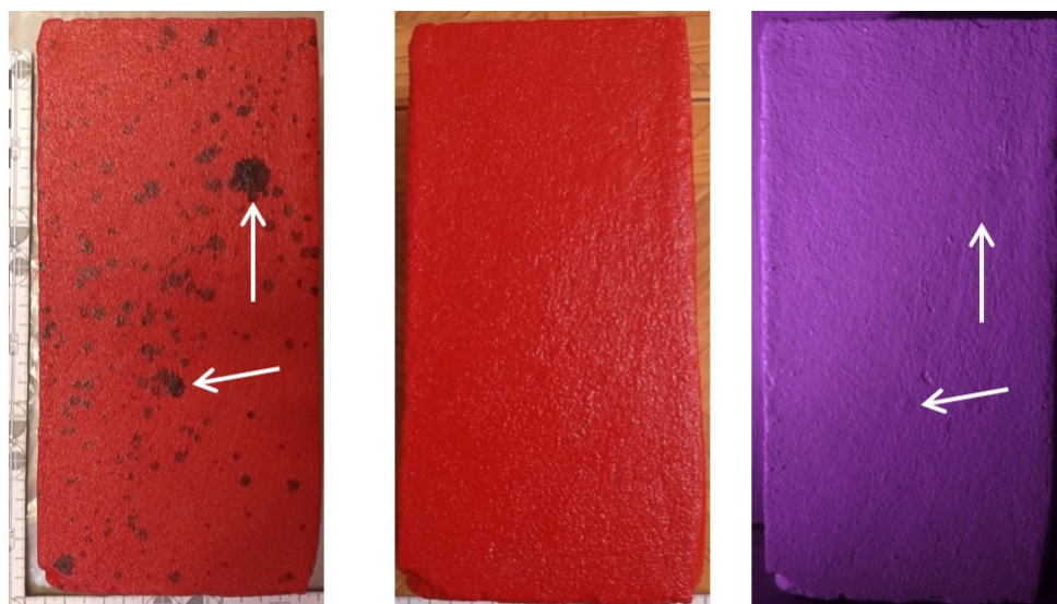
Figura 8. Detección en ladrillo de manchas por relieve e incidencia, posición y angulación de las luces IR utilizadas. Izq: Muestra EAR1. Medio: Capa 3 EAR1 totalmente cubierta. Derecha: Capa 3 EAR1 incidida con luz IR a 20cm y configuración de cámara f/5; vel 1/3 e ISO 200.
