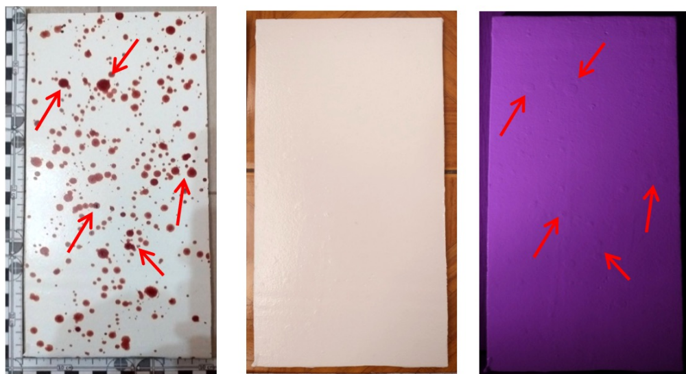
Figura 7. Detección en cartón-yeso de manchas por relieve e incidencia, posición y angulación de las luces IR utilizadas. Izq: Muestra EAB2. Medio: Capa 7 EAB2 totalmente cubierta. Derecha: Capa 7 EAB2 incidida con luz IR a 20cm y configuración de cámara f/3.4; vel 1/6 e ISO 100.
