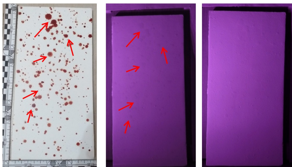
Figura 3. Comprobación de efectividad IR. Aumento del comportamiento de reflexión (bloqueador) de las pinturas LAB a lo largo de las capas aplicadas en cartón-yeso. Izq: Muestra LAB4. Medio: Capa 2 LAB4 fotografiada con luz IR a 20cm y configuración f/3.4; vel. 1/6 e ISO 100. Dcha: Capa 7 LAB4 fotografiada con luz IR a 20cm y configuración f/3.4; vel 1/6 e ISO 100.
