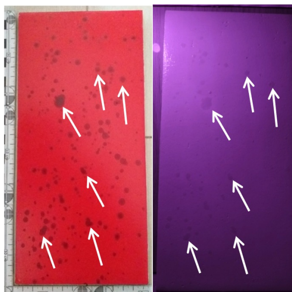
Figura 15. Configuración destacada para fotografiar paredes de cartón-yeso (transmisión). Izq: Muestra EAR2. Derecha: Muestra EAR2 totalmente cubierta, incidida con luz IR a 45° y cámara IR con f/3.4; vel 1/40 e ISO 80.
