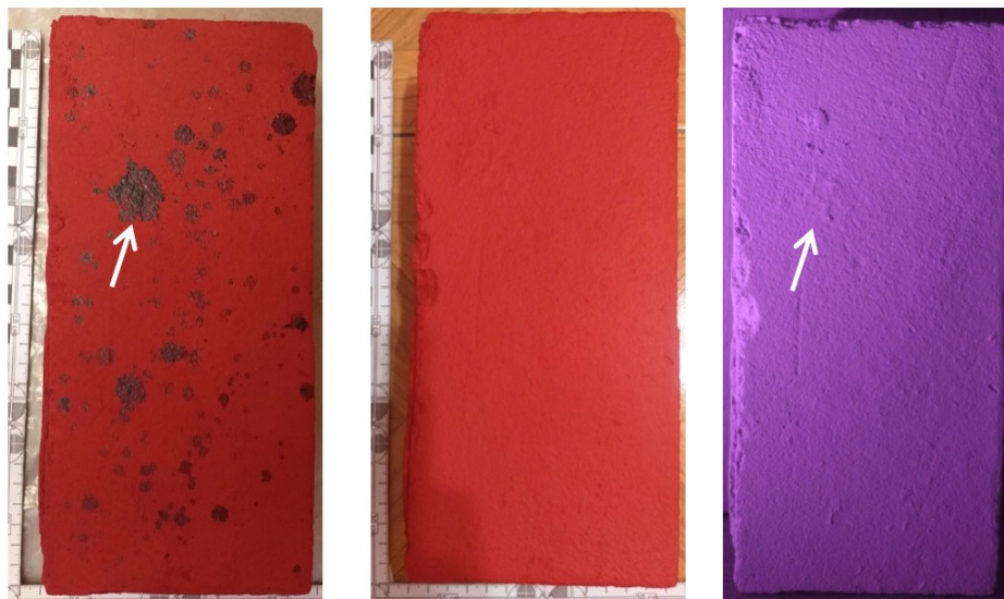
Figura 6. Detección en ladrillo de manchas por relieve e incidencia, posición y angulación de las luces IR utilizadas. Izq: Muestra LAR5. Medio: Capa 4 LAR1 totalmente cubierta. Derecha: Capa 4 LAR1 incidida con luz IR a 20cm y configuración de cámara f/3.4; vel 1/3 e ISO 200.
