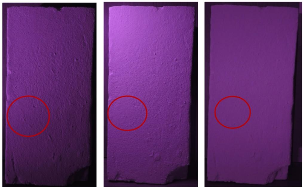
**Figura 13.** Comparativa de efectos de incidencia IR sobre la superficie de las paredes de ladrillos tratadas con Látex Acrílico. Izq: Muestra LAB4 incidida por luz IR a 20cm, acentuando detalles del revoque (configuración de cámara f/5; vel. 1/4 e ISO 80). Medio: LAB4 incidida por luz IR a 45°, iluminando sin resaltar particularidades (configuración de cámara f/3.4, vel. 1/40 e ISO 80). Dcha: LAB4 incidida por luz IR atrás, alisando las superficies (configuración f/5; vel. 1/4 e ISO 400).
