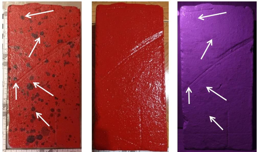
**Figura 10.** Detección en ladrillo de manchas por transmisión y absorción del IR. Izq: Muestra ESR3. Medio: Capa 5 ESR3 totalmente cubierta. Derecha: Capa 5 ESR3 incidida con luz IR a 45° y configuración de cámara f/3.4; vel 1/40 e ISO 100.
