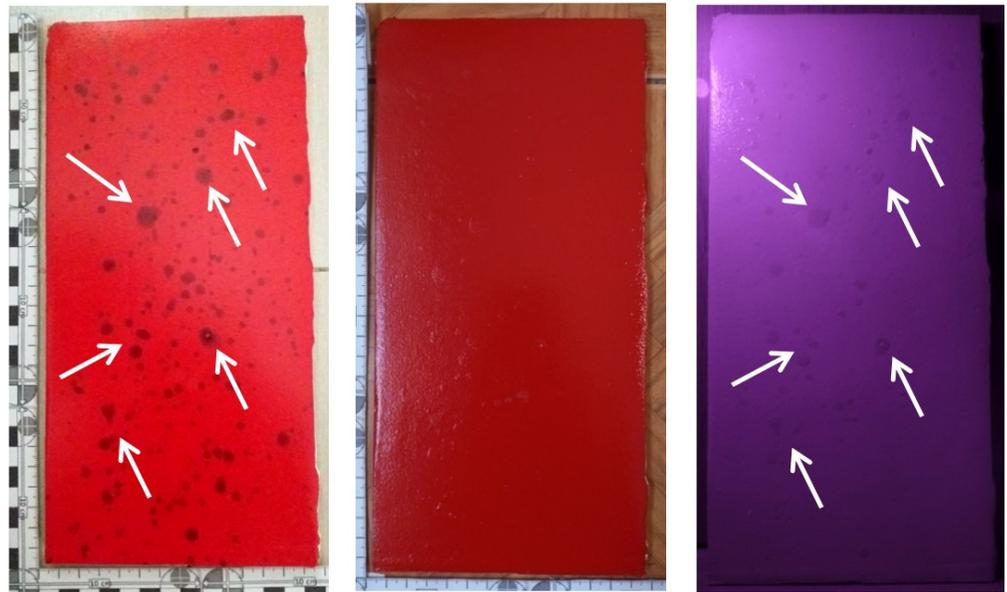
**Figura 9.** Detección en cartón-yeso de manchas por transmisión y absorción del IR. Izq: Muestra EAR3. Medio: Capa 6 EAR3 totalmente cubierta. Derecha: Capa 6 EAR3 incidida con luz IR a 45° y configuración de cámara f/3.4; vel 1/40 e ISO 80.
