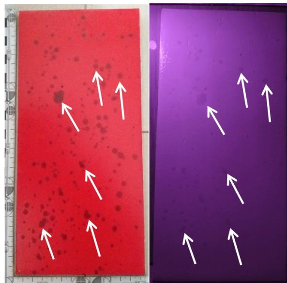
**Figura 15.** Configuración destacada para fotografiar paredes de cartón-yeso (transmisión). Izq: Muestra EAR2. Derecha: Muestra EAR2 totalmente cubierta, incidida con luz IR a  $45^\circ$  y cámara IR con  $f/3.4$ ; vel  $1/40$  e ISO 80.
