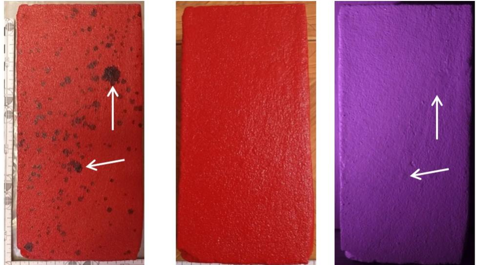
**Figura 8.** Detección en ladrillo de manchas por relieve e incidencia, posición y angulación de las luces IR utilizadas. Izq: Muestra EAR1. Medio: Capa 3 EAR1 totalmente cubierta. Derecha: Capa 3 EAR1 incidida con luz IR a 20cm y configuración de cámara f/5; vel 1/3 e ISO 200.
