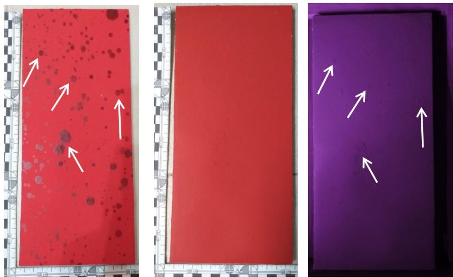
**Figura 5.** Detección en cartón-yeso de manchas por relieve e incidencia, posición y angulación de las luces IR utilizadas. Izq: Muestra LAR1. Medio: Capa 5 LAR1 totalmente cubierta. Derecha: Capa 5 LAR1 incidida con luz IR a 20cm y configuración de cámara f/3.4; vel 1/6 e ISO 100.
