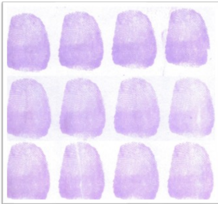
Figura 8. Secuencia de imágenes impresas en tres tipos de papel (arriba hacia abajo: 80 g/m 2 , 75 g/m 2 , 70 g/m 2 ), sin modificación del brillo (20 %) y diferente saturación (de izquierda a derecha 50 %, 100 %, 200 %, 400 %) y reveladas mediante el reactivo ninhidrina.
